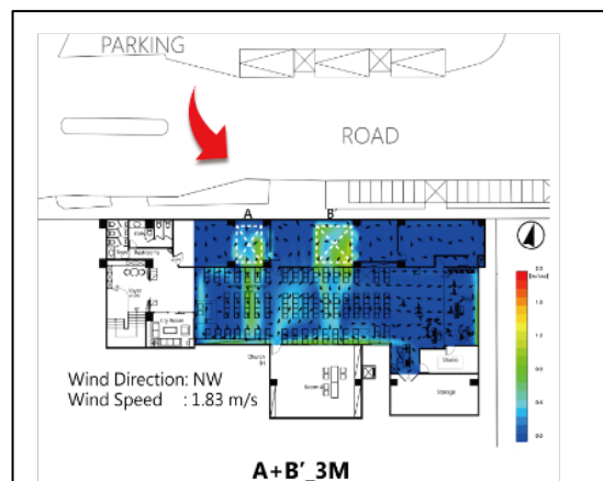
圖 11 Dry Area 設置位置 A+B' 搭配深度 1 公尺~3 公尺之 CFD 風場模擬
